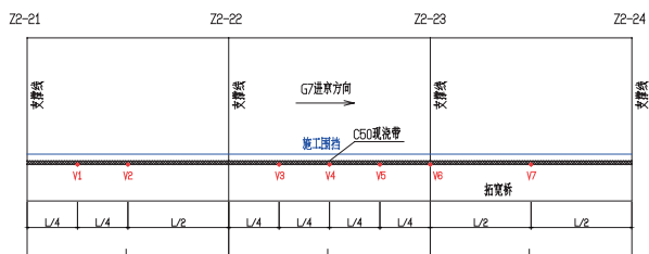
图 3 Z2 匝道第 1 联预应力混凝土连续箱梁振动参数测点布置示意图
