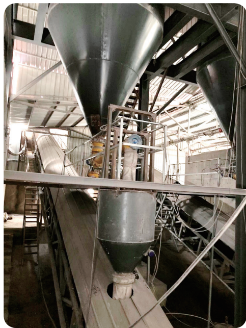
图5 改进后的硅灰上料系统
