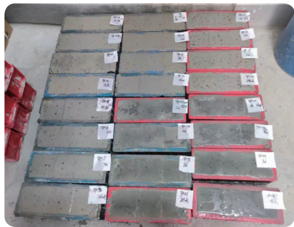
图3 混凝土试件制备
