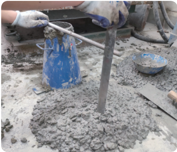
图2 混凝土坍落度试验
