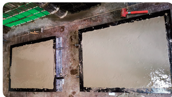
图5 平板约束收缩试验
