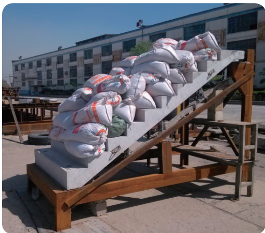
图7 普通混凝土楼梯结构性能试验
