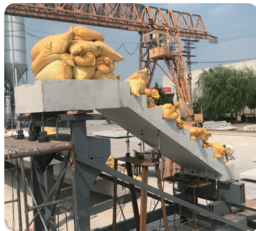
图8 再生骨料混凝土楼梯结构性能试验
