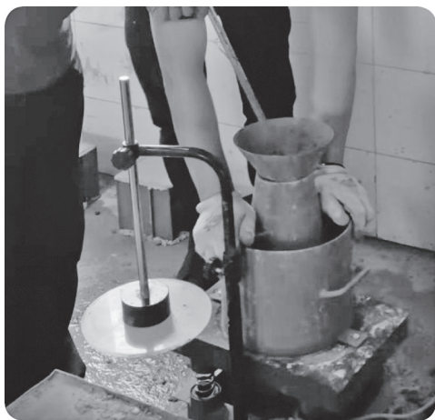
图2-1 维勃稠度仪检测干硬性混凝土工作性能(控制维勃稠度15秒-30秒)
