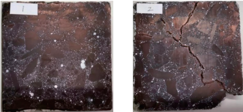
图1 出、入泵C60混凝土气泡分布测试试件
