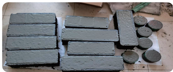
图4-5 施工现场留置的混凝土试块照片
