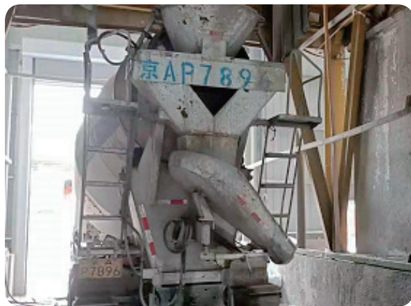
图4-7 运载耐辐照混凝土的罐车
