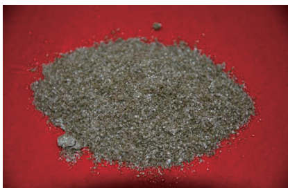
图 14 抗冻合金粉宏观样貌
